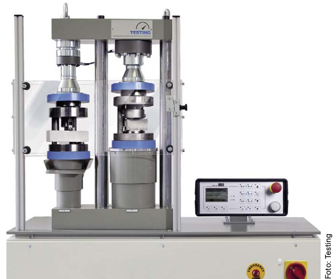
Bild 5: Prüfpresse zur Ermittlung der Betondruckfestigkeit
