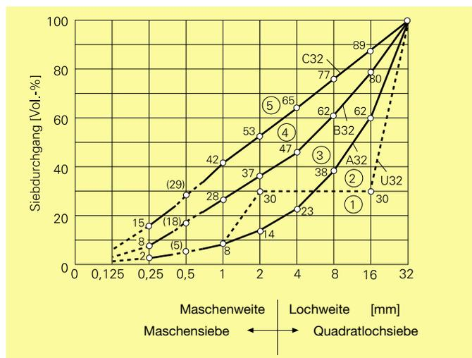
Bild 3: Regelsieblinien nach DIN 1045-2 mit einem Größtkorn von 32 mm
