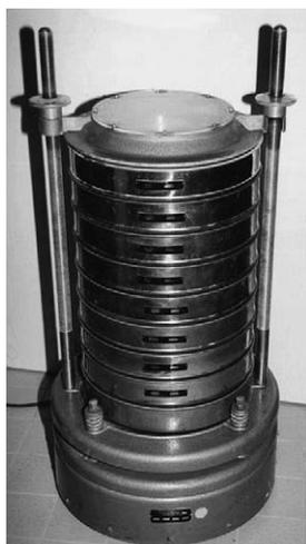
Bild 6: Siebmaschine nach DIN EN 933-1
