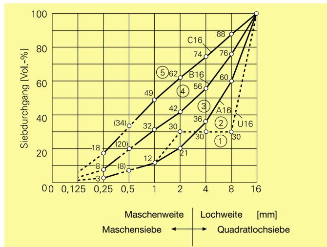
Bild 2: Regelsieblinien nach DIN 1045-2 mit einem Größtkorn von 16 mm
