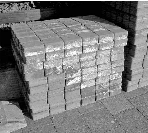
Bild 1: Ausblühungen an paketierten Pflastersteinen
